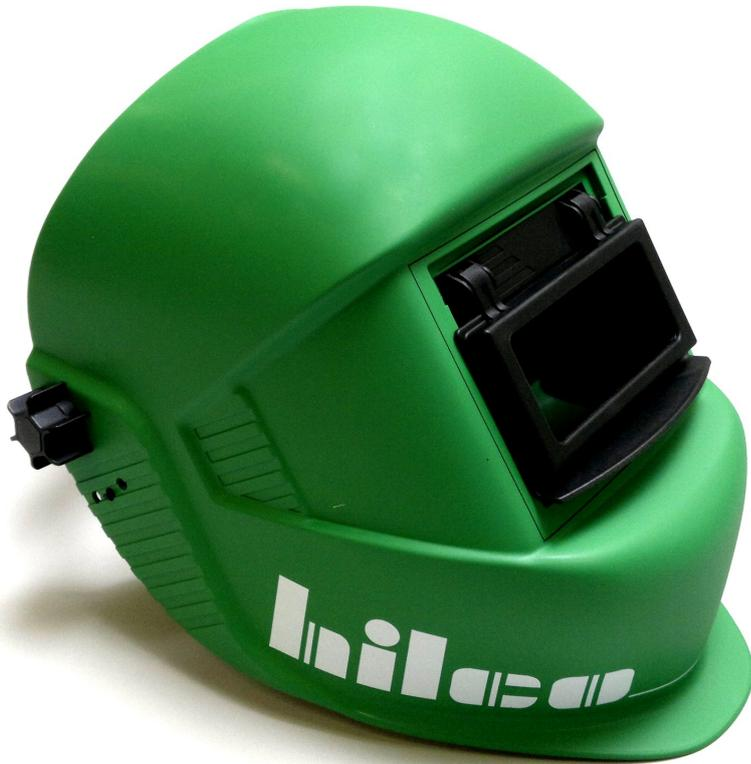
Der hochklappbare Schweißhelm ist ein leichter Helm mit maximalem Schutz für den Schweißer, optimalem Benutzerkomfort, leichter Handhabung und langer Lebensdauer. Komplett mit Kopfband, Schweißband und klappbarem Halter für ein Schutzglas der Schutzstufe 10. Erhältlich für verschiedene Größen an Schutzgläsern.
